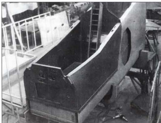
Титановая "ванна" кабины пилота Су-25
