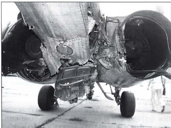
Продуманная конструкционная защита Су-25 позволяла вернуться на аэродром даже после столь тяжелых повреждений
