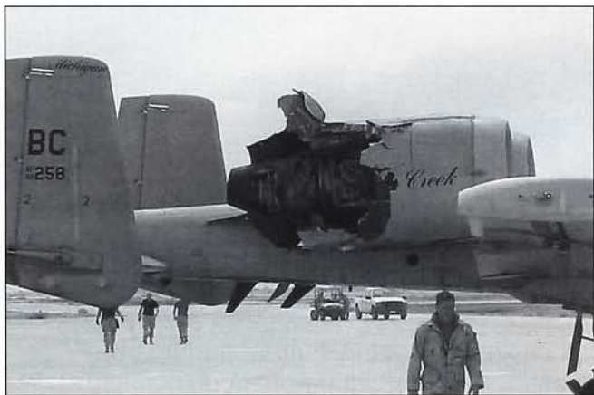
Поражение одного из двигателей не приводило к потере самолета
